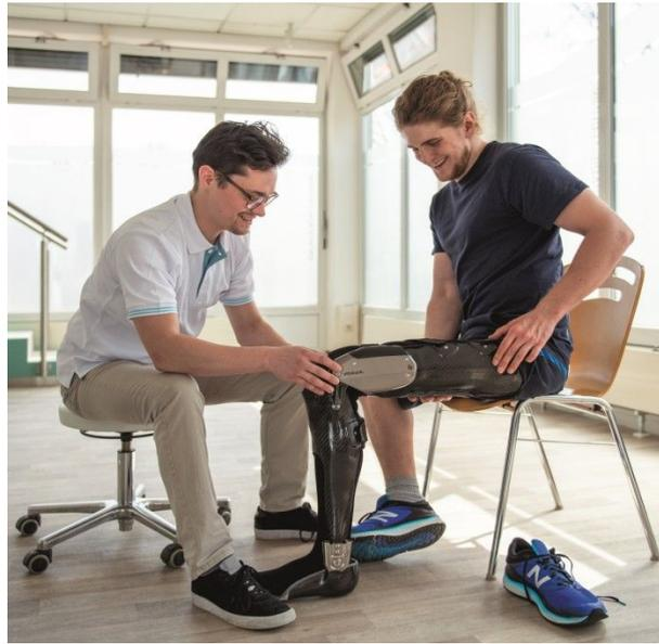
**Bild 6: Prothese, welche Biosignale in Bewegung interpretiert.**
