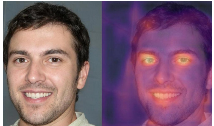
Abbildung 3: Porträtfoto des Briten Oliver Taylor (links) sowie einer Darstellung der Heatmap des Unternehmens Deepfake Detection Company Cyabra. Gefärbte Bereiche deuten hierbei auf eine Fälschung hin [35].
